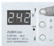
Для просмотра и изменения верхнего предела нажмите на кнопку «+». В этом состоянии кнопками «+» и «-» можно изменить верхний предел. Через 3 с после последнего нажатия кнопок, ZUBR вернется к индикации напряжения сети.
