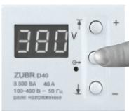
Кратковременное нажатие средней кнопки позволяет просмотреть значение напряжения, в результате которого прибор отключил нагрузку. Значение хранится в энергонезависимой памяти.
