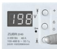
Для просмотра и изменения нижнего предела нажмите на кнопку «-». В этом состоянии кнопками «+» и «-» можно изменить нижний предел. Через 3 с после последнего нажатия кнопок, ZUBR вернется к индикации напряжения сети.
