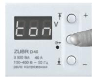
Второе кратковременное нажатие средней кнопки отобразит на индикаторе «top». При отпуске кнопки мигающее значение времени задержки включения нагрузки можно изменить кнопками «+» или «-». Время задержки можно менять от 3 до 600 с, шаг изменения 3 с. Через 3 с происходит возвращение к индикации напряжения сети.
