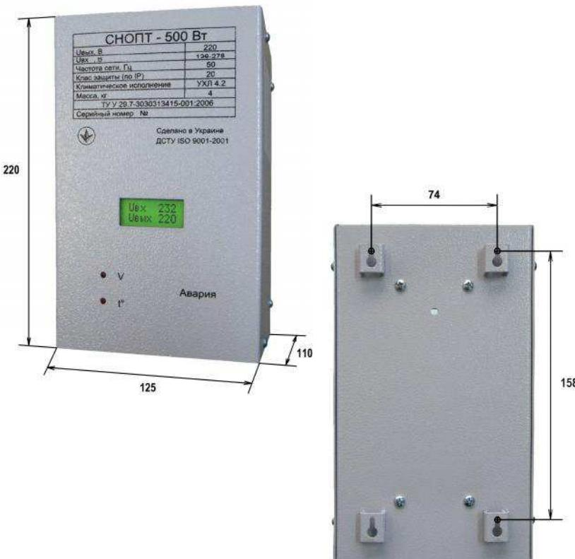
Подключите к стабилизатору вилку электропотребителя затем подключите вилку стабилизатора к электросети. Включите тумблер, после самодиагностики жидкокристаллический индикатор начнет отображать входное и выходное напряжение.
