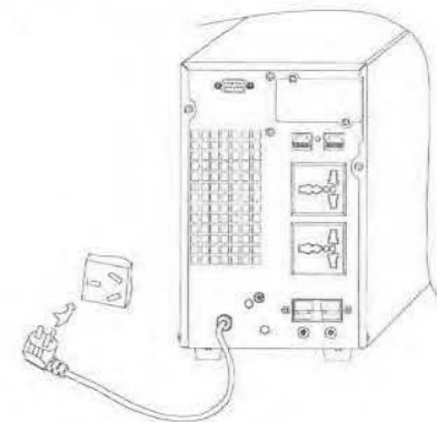
Рисунок 3-1 Метод соединения кабеля ввода
