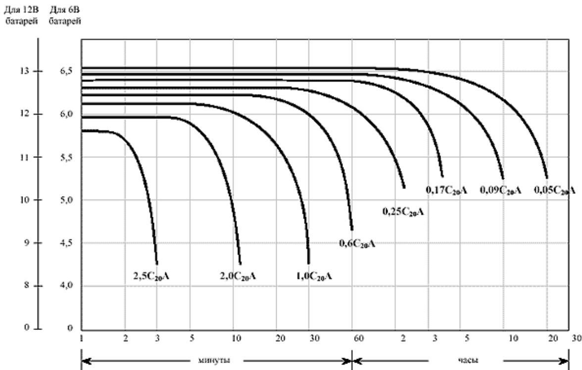
Рис. 3. График разрядных характеристик при различных скоростях разряда
