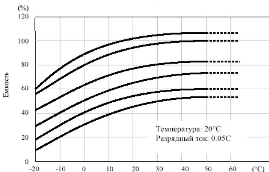
Рис. 4. Зависимость емкости батареи от рабочей температуры.
