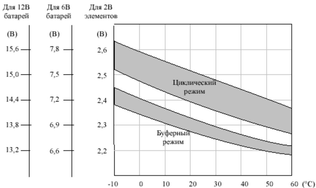
Рис. 2. График зависимости между температурой и зарядным напряжением
