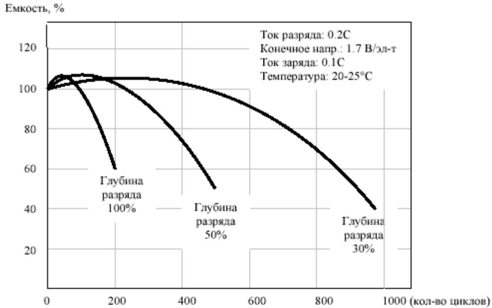
Рис. 8. Количество циклов при разной глубине разряда
