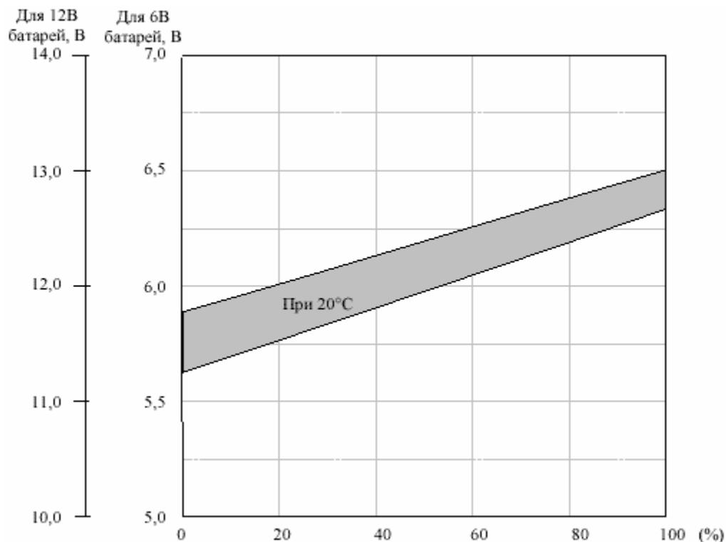
Рис. 7. Зависимость емкости от напряжения холостого хода
