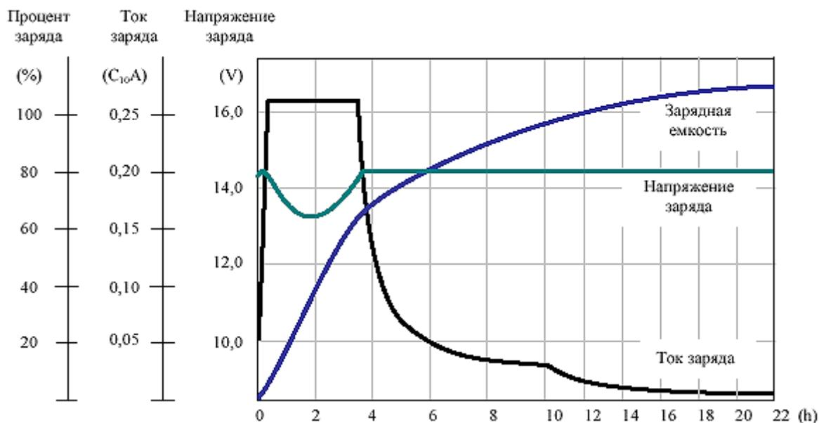
Рис. 1. График заряда батареи после глубокого разряда.
