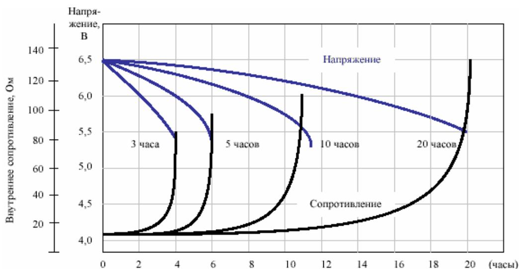
Рис. 5. Зависимость внутреннего сопротивления от степени разряда
