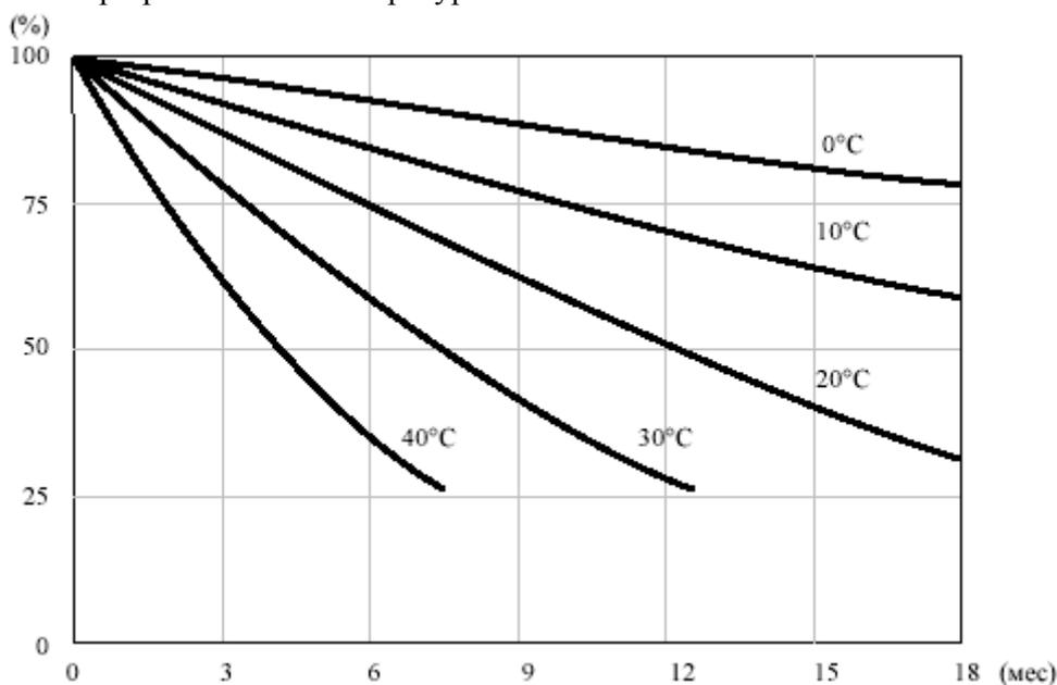
Рис. 6. Зависимость остаточной емкости батареи от времени хранения
